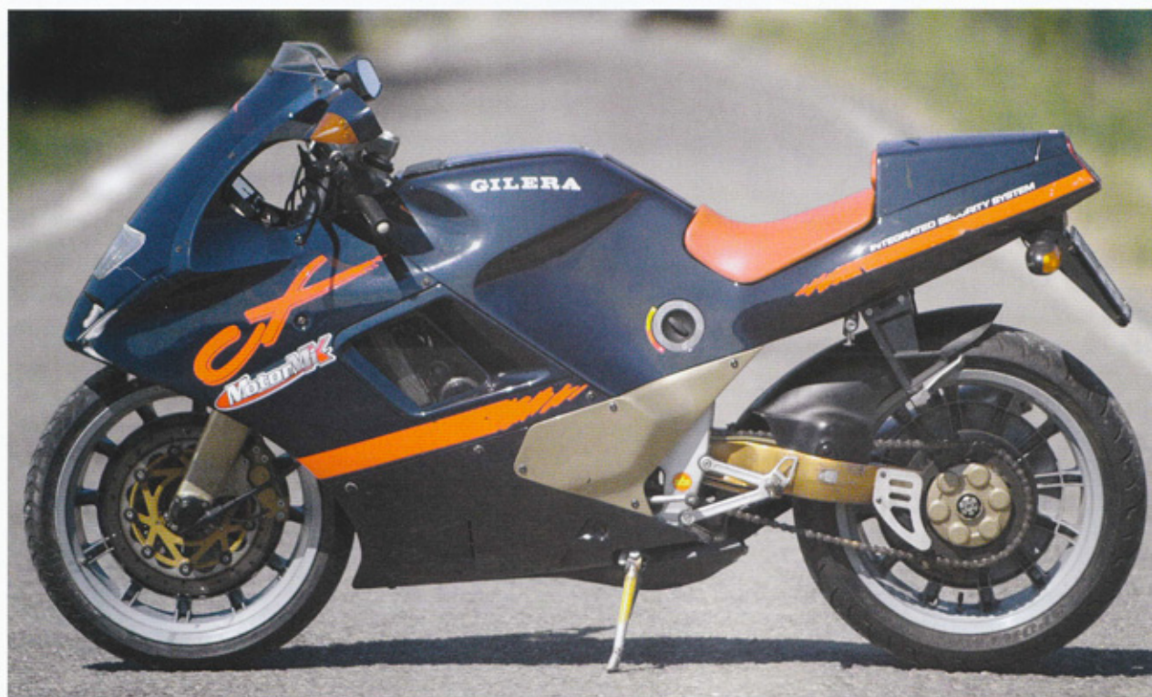
Le Gilera CX 125 che illustrano il servizio appartengono alla collezione di Franco Ferretti di Reggio Emilia. La linea della moto è fortemente caratterizzata dalle sospensioni monobraccio, che lasciano libere le ruote sul lato destro. La vista laterale evidenzia il profilo del cupolino. La sella è biposto, con il cuscino per il passeggero nascosto da un coperchio in plastica, in tinta con il codone, fissato con una serratura.
