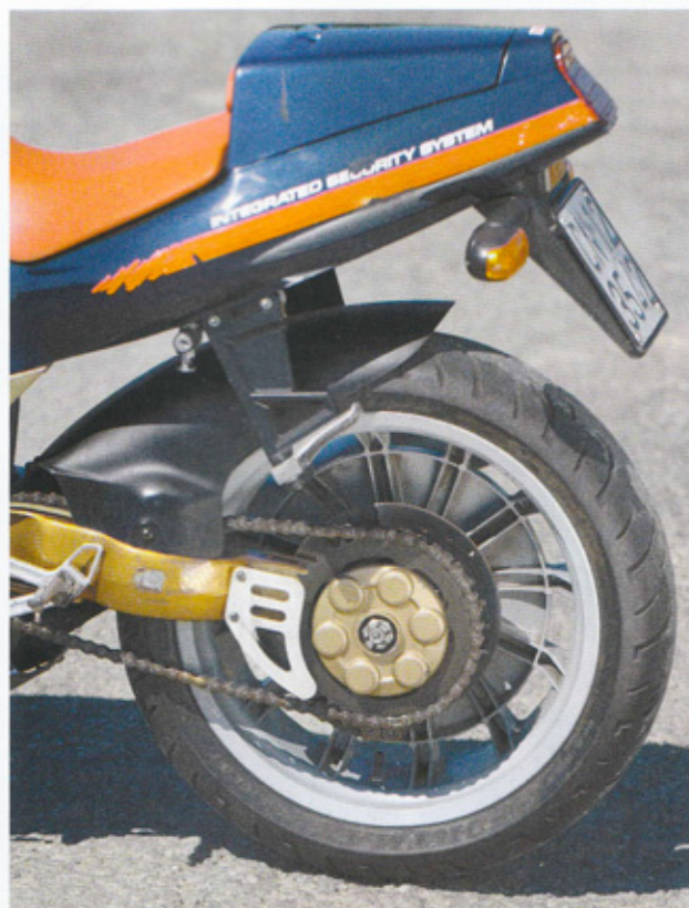
La sospensione posteriore è a forcellone oscillante monobraccio in lega leggera con un gruppo molla ammortizzatore Boge ad articolazione progressiva "Power Drive". L'escursione della ruota è di 135 mm.
