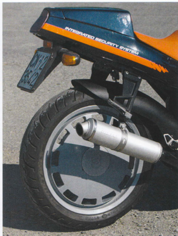
Il forcellone e la forcella monobraccio sono coperti da brevetto Gilera. La ruota monolitica in lega leggera da 17" è montata a sbalzo. Il freno a disco fisso da 240 mm e la corona sono montate sullo stesso lato.
