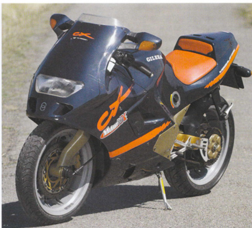
Le Gilera CX 125 che illustrano il servizio appartengono alla collezione di Franco Ferretti di Reggio Emilia. La linea della moto è fortemente caratterizzata dalle sospensioni monobraccio, che lasciano libere le ruote sul lato destro. La vista laterale evidenzia il profilo del cupolino. La sella è biposto, con il cuscino per il passeggero nascosto da un coperchio in plastica, in tinta con il codone, fissato con una serratura.
